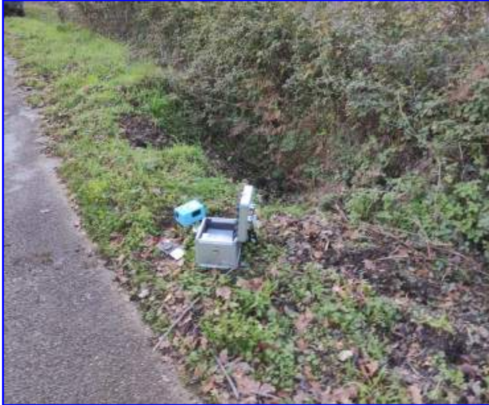
Fig. 1 – Prospezione a sismica passiva HVSR n. 8 effettuata sul sito di interesse progettuale.
