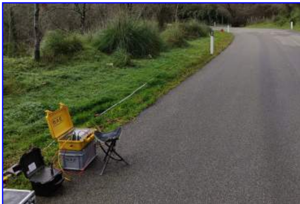
Fig. 1 – Prospezione sismica MASW n. 2 effettuata in area progettuale.
