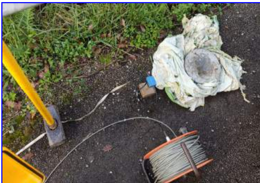
Fig. 3 – Sorgente energizzante, costituita da massa battente su piastra di alluminio. Come starter/trigger è stato utilizzato un geofono verticale Geospace a 14Hz.
