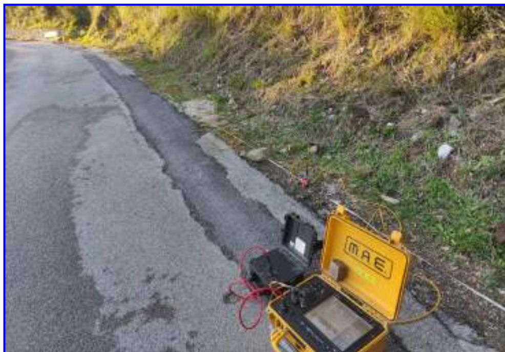
Fig. 1 – Prospezione sismica MASW n. 5 effettuata in area progettuale.
