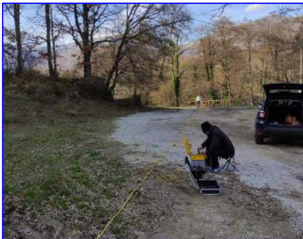
Fig. 1 – Prospezione sismica MASW n. 7 effettuata in area progettuale.
